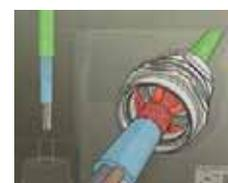
Das durchgeführte Kabel kann mit der bei den Euro-Top EMV Verschraubungen angewandten Kontaktierung nicht nur am Kabelende kontaktiert werden, sondern auch bei Weiterführung des Kabels innerhalb des Gehäuses. Dazu muss - wie im untenstehenden Bild gezeigt – der Kabelmantel nur für ein kurzes Stück innerhalb der Verschraubung entfernt werden.
